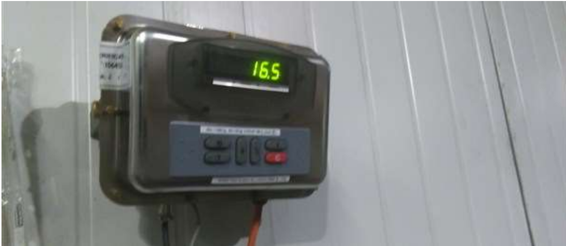
Fotografía 005 – Balanza electrónica calibrada – Nota: La balanza puede pertenecer al recinto donde se realiza la inspección, pero debe poseer un certificado de calibramiento.
